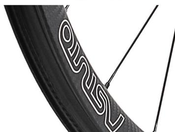
1. タイヤ取付けが簡単なこのリムのビードは、フックレスで、チューブレスタイヤを格闘することなく簡単に取付けられる設計。
